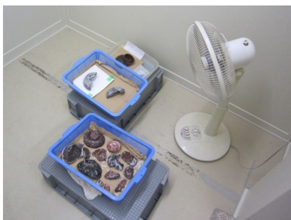
Figure 3 扇風機を用いた風乾
