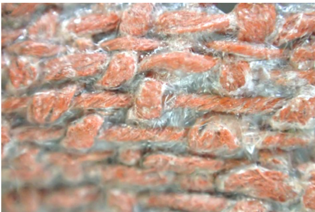
Figure 19 固形分を与え過ぎて過剰な固化物に覆われた布表面
