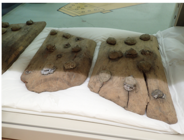
Figure 11 高級アルコール処理済 挟み板
