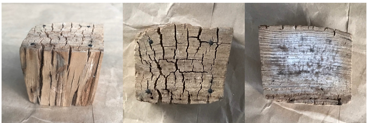
Figure 3 ラクチトール含浸後1週間静置したテストピース（中：上面、右：下面）
