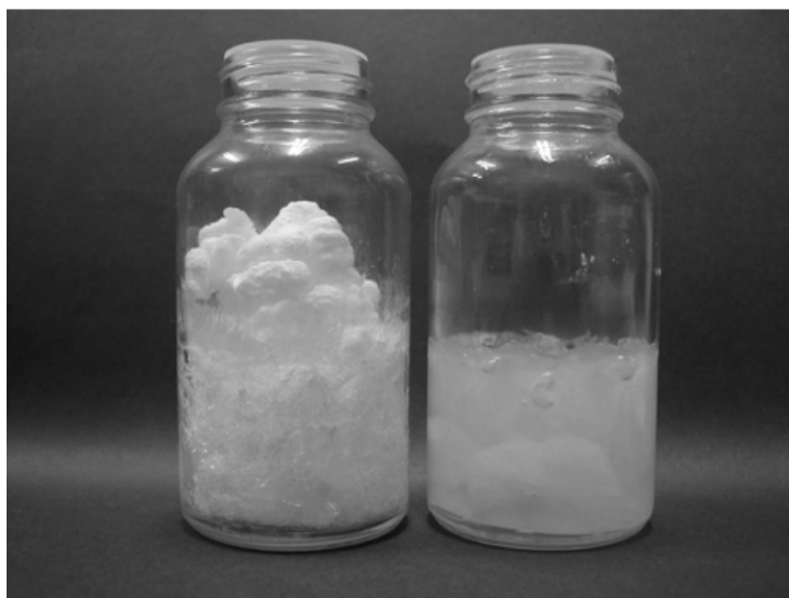
Figure 2 ラクチトールの三水和物結晶（左）と一・二水和物結晶（右）
