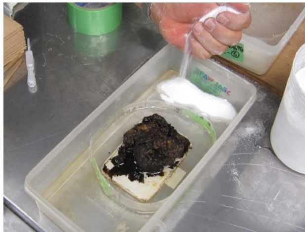
Figure 28 含浸処理
