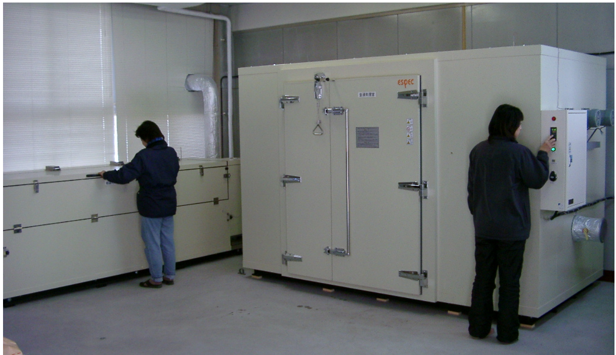
Figure 4 含浸処理室（右）と結晶化促進室（左）
