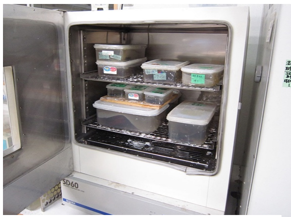
Figure 1 熱風乾燥機を用いた加熱含浸
