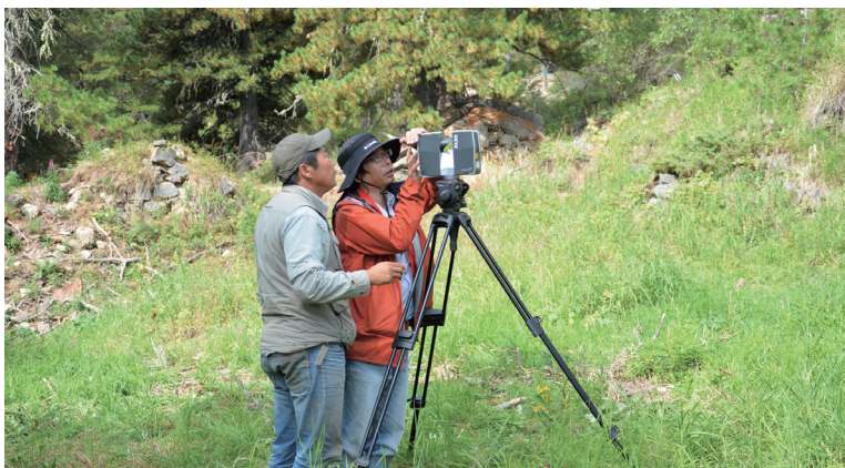
図5 3次元レーザ計測装置を利用して計測している様子
