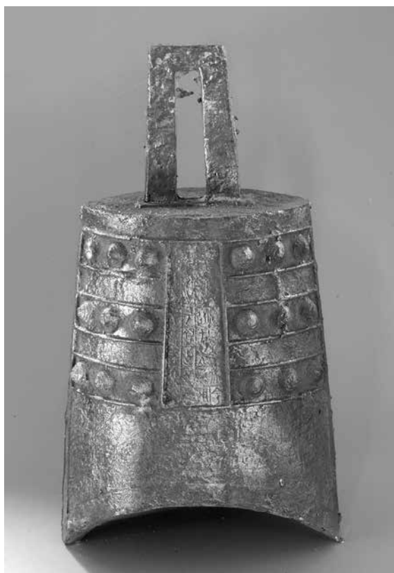
挿図 31. 鑄造実験で製作した鐘 (左：全景 右上：舞部 右下型持ちのある篆間)
