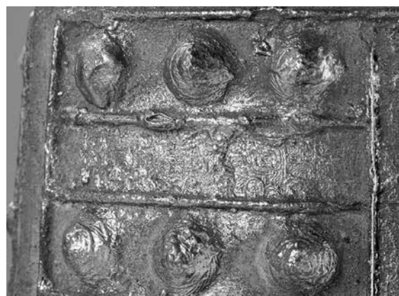
挿図 31. 鑄造実験で製作した鐘 (左：全景 右上：舞部 右下型持ちのある篆間)
