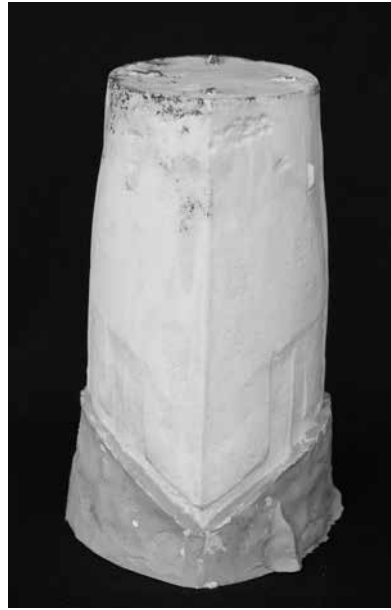
2. 編鐘第4器内面の型（側面）
