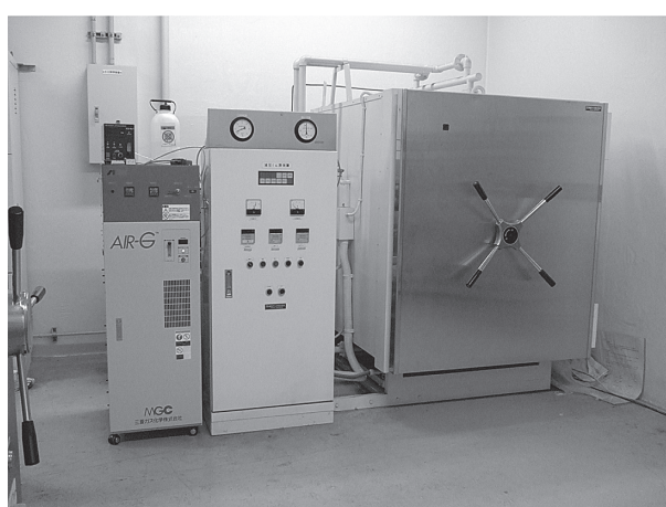
図8 大型調湿窒素発生装置と減圧燻蒸装置を組み合わせた装置 (徳島県立博物館)
