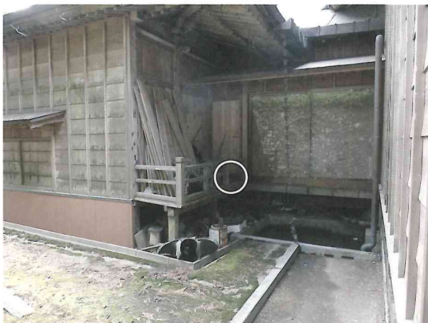
図7 大師堂裏（外気）のデータロガー設置状況
